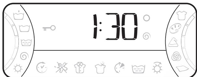
При нажатии кнопки ПУСК/СБРОС (Start/Reset) для запуска программы на дисплее показывается приблизительное время, остающееся до завершения цикла. В случае установки отложенного старта программы (пуск по таймеру, см. с. 7) дисплей будет показывать время, оставшееся до начала стирки.
